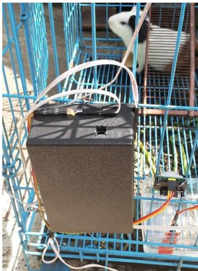
Gambar 18. Implementasi alat Sistem Monitoring dan Automatic Feeding Tampak Belakang
