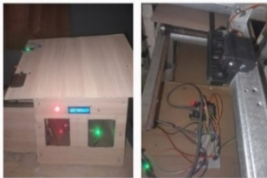
Gambar 7. Tampilan Implementasi Prototipe Atap Jemuran Otomatis
