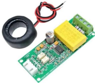
Gambar 4. Memperlihatkan bentuk dari sensor arus dan tegangan PZEM-004t
