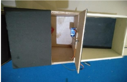
Gambar 7. Motor Servo Mengangkat Penutup Keranjang
